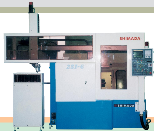
Manipulador tipo pórtico com 2 eixos e magazine de peças rotativo
