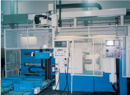
Manipulador tipo pórtico com 3 eixos e com trocador de bandejas
